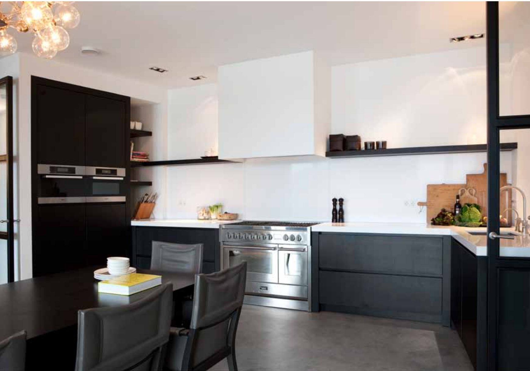
De keuken is zelfontworpen en gemaakt door een lokale interieurbouwer. De werkbladen zijn van wit composiet, de frontjes van zwart-bruin gebeitst eiken. De kraan van Dornbracht heet Tara Classic.
